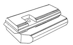
120L Kraftstoffbehälter aus Aluminium, der an Stelle des ursprünglichen 65L Tanks eingebaut werden kann.
