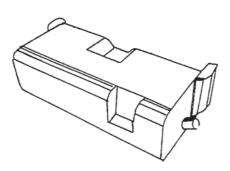
155L Kraftstoffbehälter aus Aluminium, der an Stelle des ursprünglichen 70L Tanks eingebaut werden kann.
