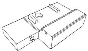
140L Kraftstoffbehälter aus Aluminium, der an Stelle des ursprünglichen 70L Tanks eingebaut werden kann.
