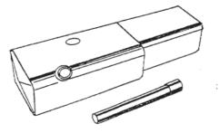
120L Kraftstoffbehälter aus Aluminium, der an Stelle des ursprünglichen 70L Tanks eingebaut werden kann.
