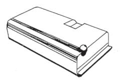
130L Kraftstoffbehälter aus Aluminium, der an Stelle des ursprünglichen 65L Tanks eingebaut werden kann.
