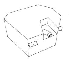
140L Kraftstoffbehälter aus Aluminium, der an Stelle des ursprünglichen 65L Tanks eingebaut werden kann.
